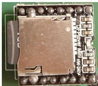
Die SD-Karte wird entfernt, indem Sie leicht seitlich gegen die Karte drücken (im Bild oben von links nach rechts leicht drücken). Die SD-Karte wird von einer Feder ein kleines Stück aus dem Schlitz herausgeschoben. Sie können die SD-Karte jetzt ohne Kraft entnehmen. Ziehen Sie die SD-Karte nicht nach oben, sondern nur zur Seite. Wenn Sie nach oben ziehen, kann der Karten-Slot abreißen.
